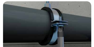
6. Aperte o parafuso da abraçadeira com o binário de aperto recomendado
