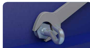
5. Aperte a bucha com uma chave dinamométrica
