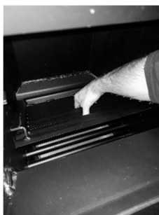
Figura 16 - Limpeza da câmara de combustão
