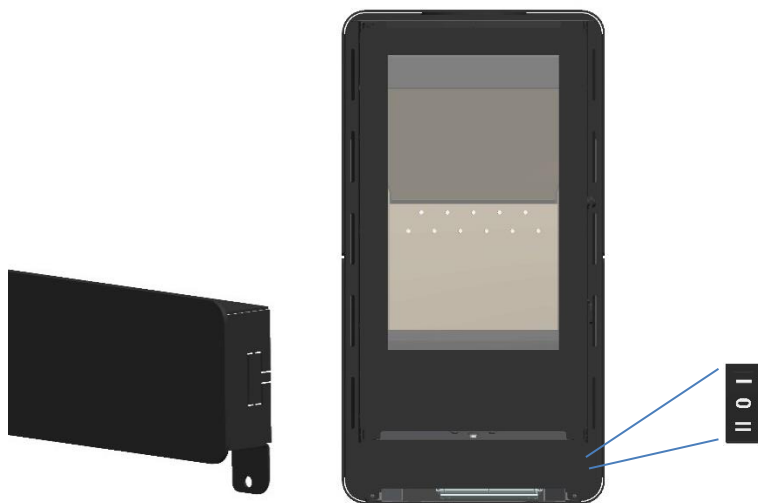
Figura 41 - Fixação do switch na tampa frontal
