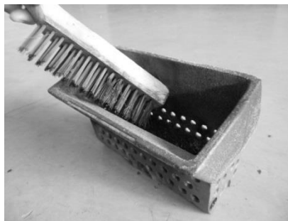
Figura 52 - Limpeza do cesto de queima
