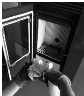
Figura 60 - Limpeza do vidro: a) aplicar líquido no pano; b) limpar o vidro com o pano
