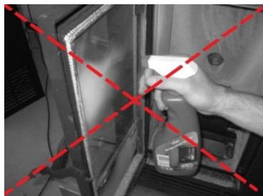
Figura 59 - Limpeza incorrecta do vidro
