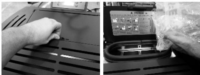
Figura 17 – Abastecimento do depósito de pellets
