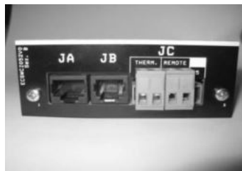
Figura 30 – Comando externo (cronotermostato) e interface de ligação – ambos não incluídos.
