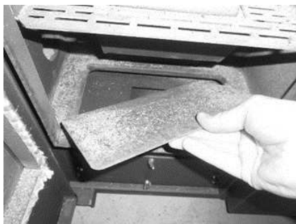
Figura 118 - Limpeza do interior da salamandra
