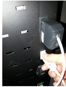
Figura 22 – Ligação do motor do silo e dos sensores à placa eletrônica
