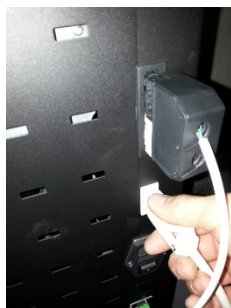
Figura 41 – Ligação do motor do silo e dos sensores à placa eletrônica
