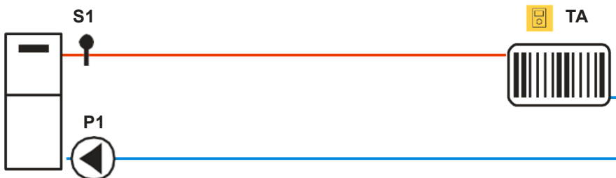
Figura 48 – Ligação simples apenas a radiadores de aquecimento central
